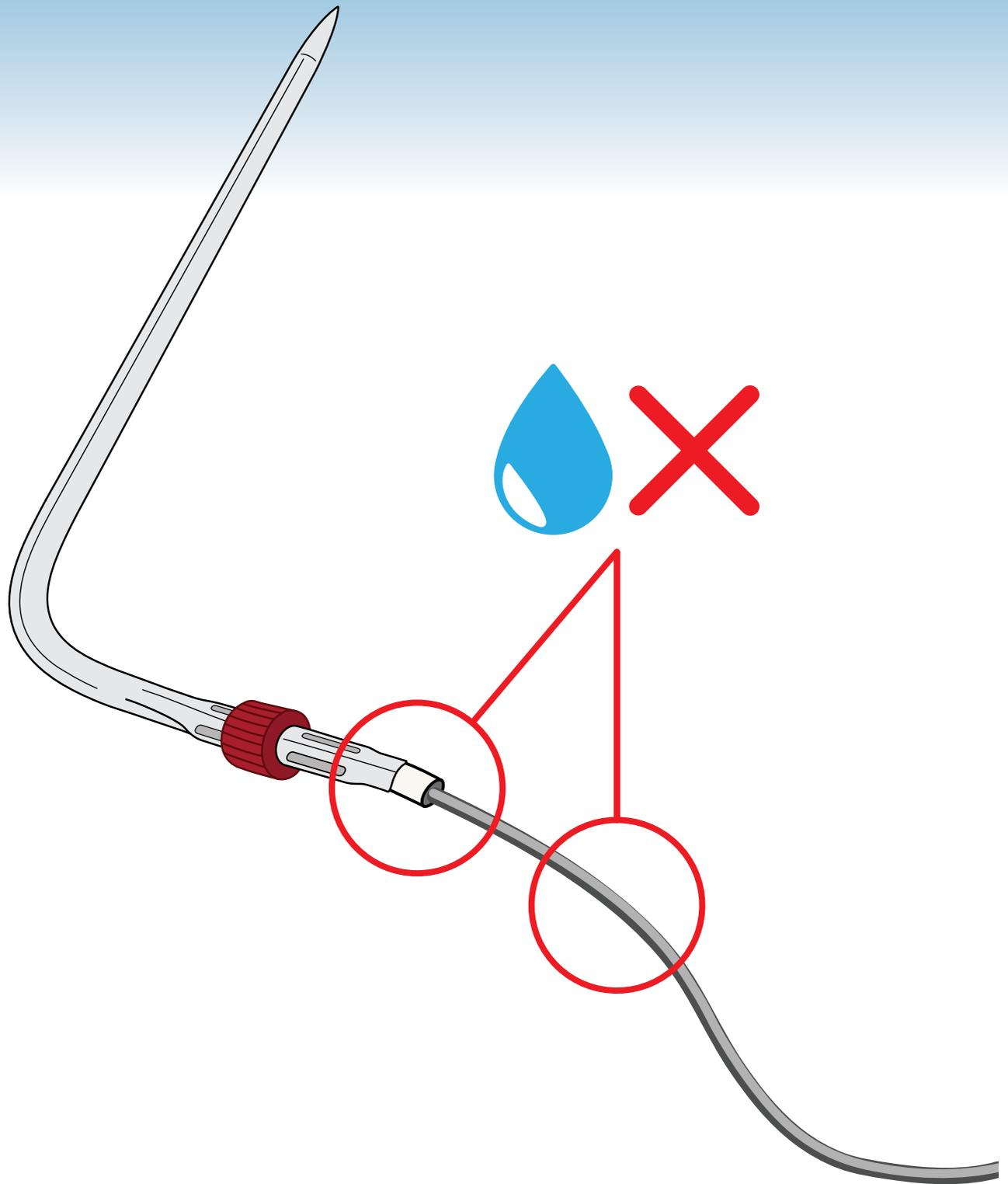
Beim Reinigen von Temperaturfühlern Vorsicht walten lassen, damit das Kabel und der Eingang des Kabels in den Fühler nicht mit Wasser in Berührung kommen.
