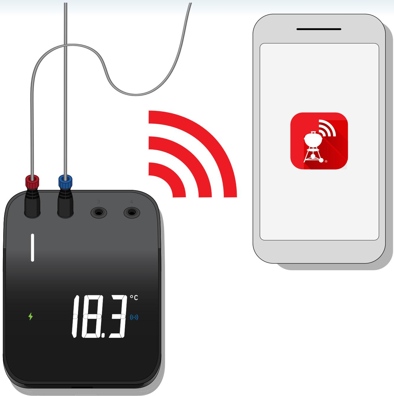
Die Weber Connect App auf dem Smartphone öffnen und darauf achten, dass der Weber Connect Smart Grilling Hub innerhalb der Reichweite ist.
